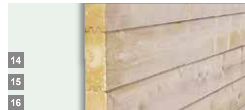
Blockbohlen 45 x 121 mm, 70 x 146 mm (mit Doppel-Nut und -Feder), 90 x 146 mm (mit Dreifach-Nut und -Feder), 4-seitig gefast
