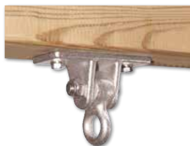
25 Schaukelhaken verzinkt, für Schaukeln, mit Messinglager und Sicherheitsmutter zur Aufhängung an der Unterseite der Querstange. Schraubenlöcher Ø 13 mm, Öse für die Befestigung von Seilen oder Ketten mit Ø 20 mm. Gesamtmaß 130 x 50 x 100 mm.
