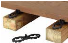
Terrassengleiter / Abstandshalter (Optimale Entwässerung für konstruktiven Holzschutz)
