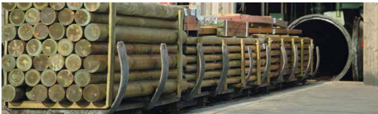
Loren mit Gartenholz – Beladen der Kesseldruckanlage
